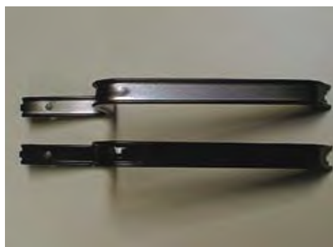
Img. 2.4.1. Poor wrap-around
